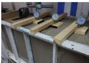
**Рисунок 1 - Общий вид установки (модели фундаментов и источник колебаний)**
