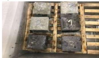
**Рисунок 2 – Испытание образцов на морозостойкость**
