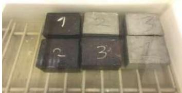
**Рисунок 1 – Испытание образцов на водопоглощение**
