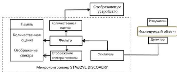
**Рисунок 2 – Блок-схема концептуального глюкометра**
